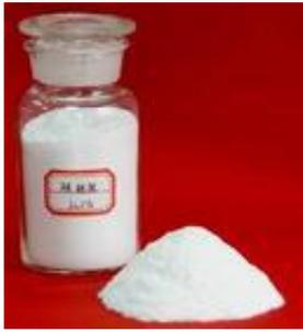
碳酸锂，一种无机化合物，化学式为 $\text{Li}_2\text{CO}_3$ ，为无色单斜晶系结晶体或白色粉末。密度 $2.11\text{g/cm}^3$ 。熔点 $618^\circ\text{C}$ 。溶于稀酸。微溶于水，在冷水中溶解度较热水下大。不溶于醇及丙酮。可用于制陶瓷、药物、催化剂等。常用的锂离子动力电池原料。
