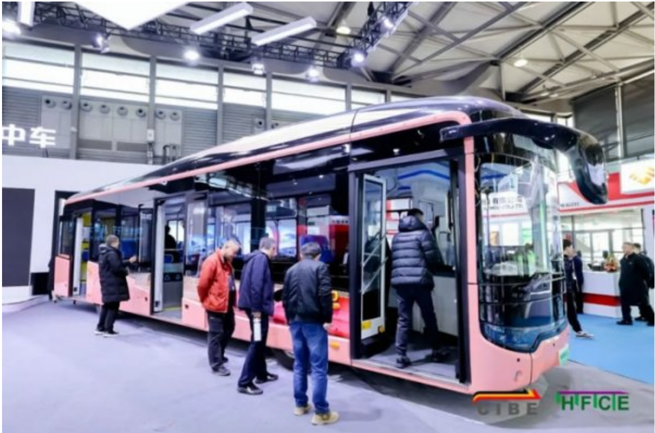
11米氢燃料电池客车，则采用万象独有的模糊控制技术，在满氢满电情况下可实现高达500公里续航，百公里氢耗国内领先。
