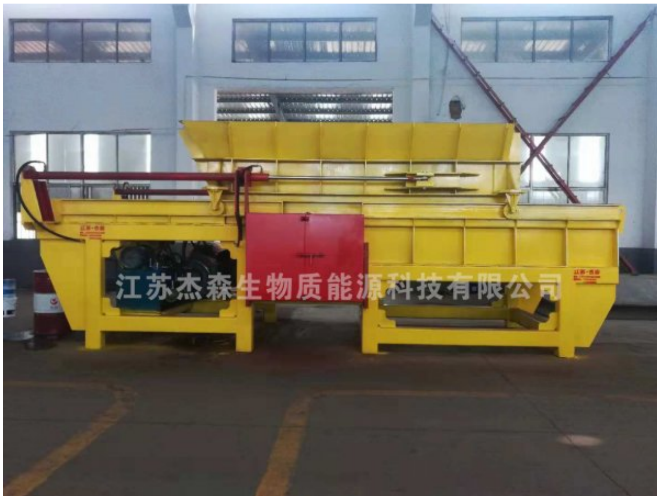
P760破碎机（无尘、低能耗、更换锤头价格极低）
