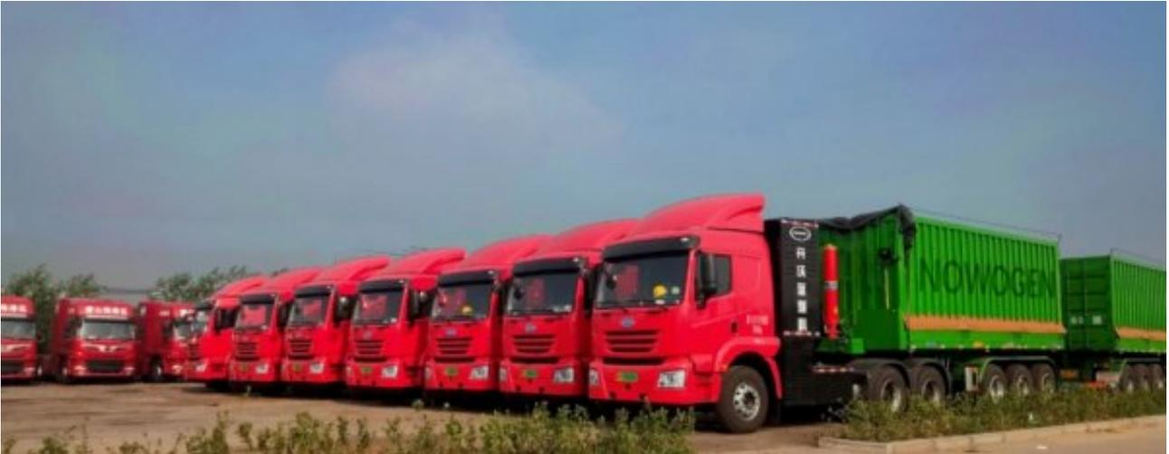
这批重卡也是京津冀地区首批上牌运营的氢能重卡，这款车型由开沃重工设计制造，配备110Kw燃料电池系统，连同挂车总质量达到49吨。该款车型的载质量利用系数高，载货量30吨，满足了客户多拉快跑的需求。
