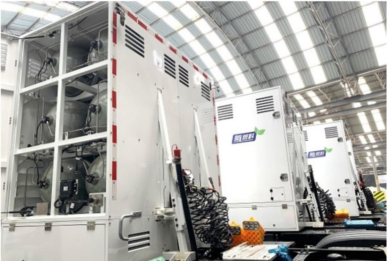
储氢部分，智蓝氢燃料重卡首创6个385L氢瓶储供氢系统，单氢瓶储氢量属当前行业内最大容积，动力强劲，续航更强。
