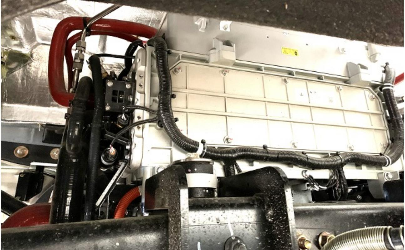
自主开发的整车控制器VCU,优化标定后的制动能量回收策略，在行车制动时优先使用电机进行能量回收，保证车辆的高效节能。
