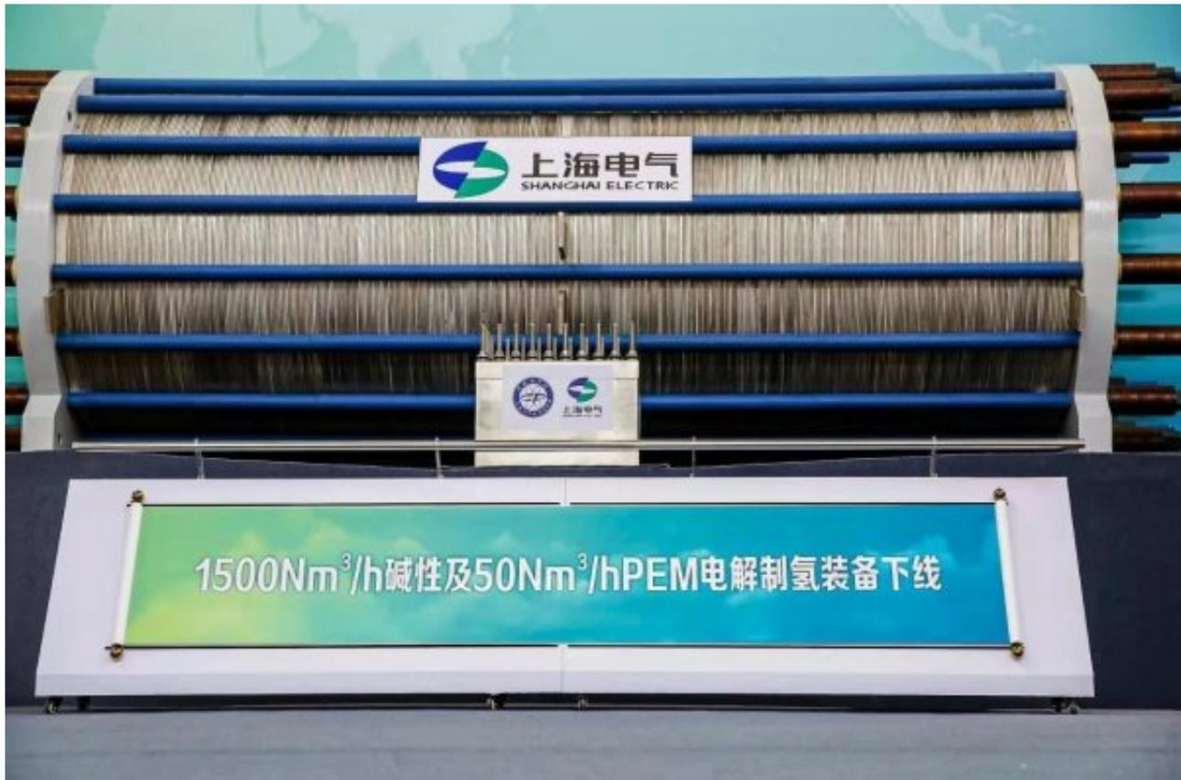
仪式上发布了两款制氢装备新产品，其中“碱性电解水制氢装备”，单体产氢量达到1500Nm<sup>3</sup>/h，采用高性能、新型电极，设备整体具有电解效率高、使用寿命长、投运成本低等特点。另一款新品“PEM电解水制氢装备”，单体产氢量达到50Nm<sup>3</sup>/h，采用高活性催化剂及高导电耐腐蚀双极板，具有电流密度高、能耗低、动态响应速快等特点。两款产品通过模块化设计均可满足集成化、大规模的绿氢制备需要，目前已达国内领先水平。
