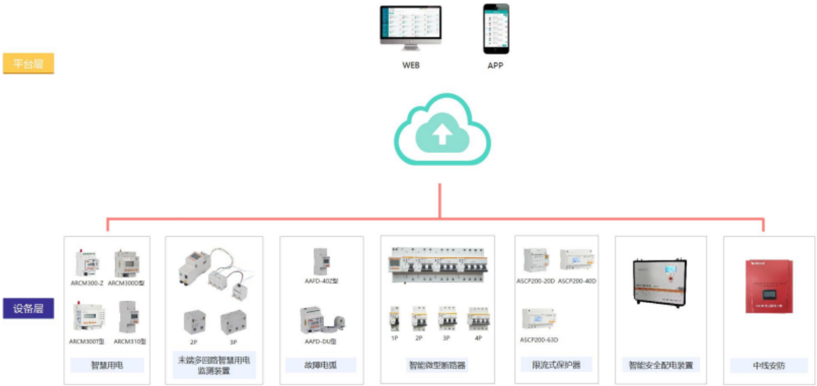
智慧安全用电管理云平台硬件配置
