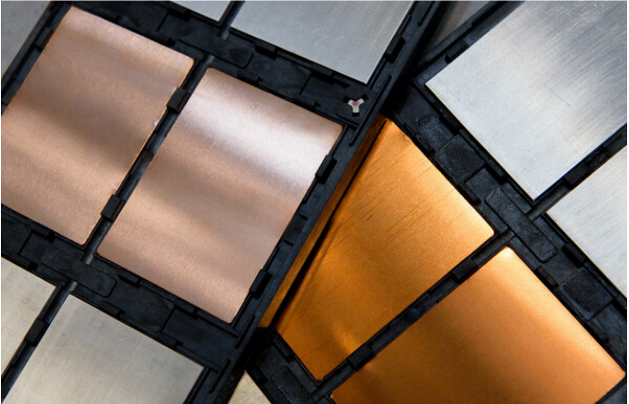
经REDOX-Tool处理后铜板（左）和氧化铜板（右）对比。无氧化物层铜板和有氧化物层铜板之间的差异清晰可见。 （版权所有：Plasmatrete GmbH）
