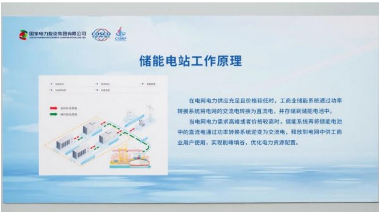
在电网电力供应充足且价格较低时，储能电站可通过功率转化系统将电网的交流电转换为直流电，并存储到储能电池中；当电网电力需求高峰或者价格较高时，储能系统再将储能电池中的直流电通过功率转换系统逆变为交流电，释放到电网中供工商业用户使用，实现削峰填谷，优化电力资源配置。
