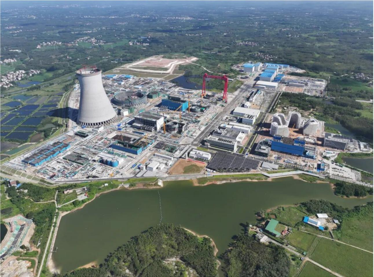
廉江核电1号机组冷却塔塔高218.7米，零米直径174.6米，淋水面积达两万平方米，混凝土浇筑总量达13.74万立方米，建设6台百万千瓦级核电机组，总装机容量850万千瓦。全部机组投运后，可满足粤西地区全社会用电需求，每年可减少标煤消耗约2000万吨，减排二氧化碳约5200万吨，环保效益相当于种植14.8万公顷阔叶林。
