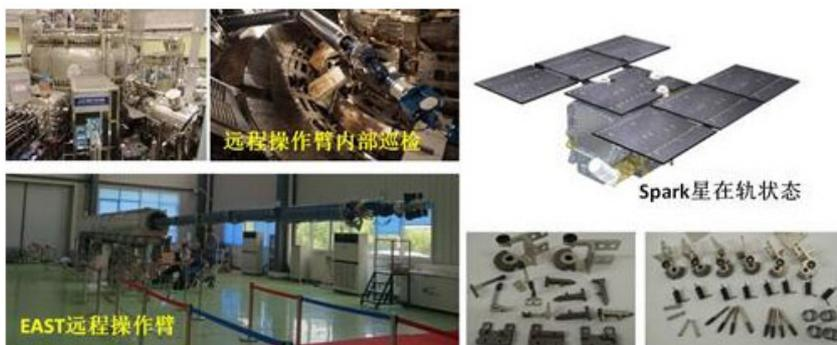
图3. EAST托卡马克装置远程操作臂及Spark微小卫星太阳能帆板二次展开机构的润滑与防护
