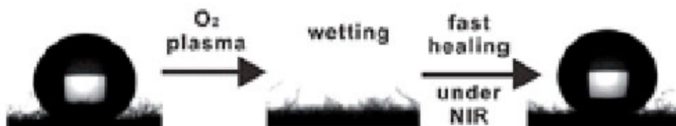
光热效应致快速自修复超疏水示意图
